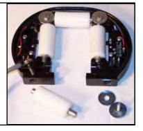
STEP 3: INSERT CABLE AND REASSEMBLE
