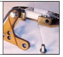
STEP 2: REMOVE HEX HEAD SCREWS AND ROLLER
